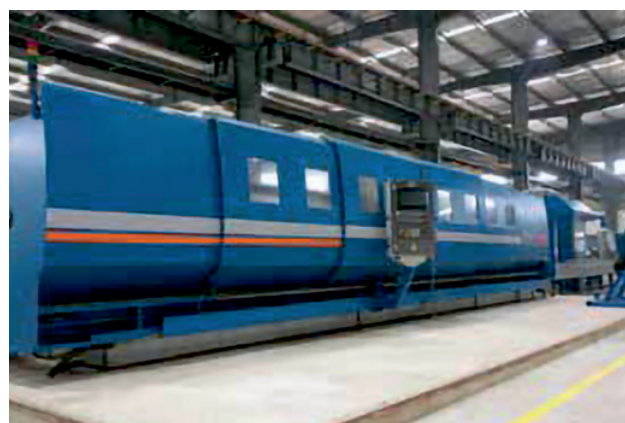
5-осевой станок для металлообработки роторов Диаметр роторов – до 300 мм
