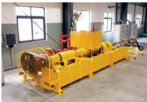
Испытательный стенд для скважинных насосов
