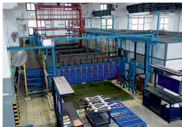
Установка для нанесения упрочненного хромистого покрытия на роторы Длина – до 8500 мм
