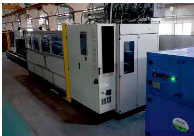
Станок для запрессовки статоров Длина статоров – до 8000 мм
